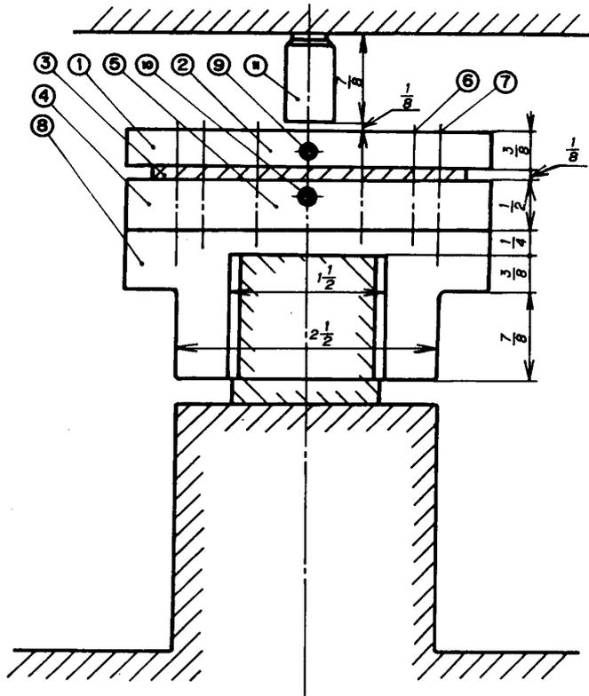
① Die holding plate ② Upper die ③ Plate (Specimen) ④ Die holder ⑤ Die
