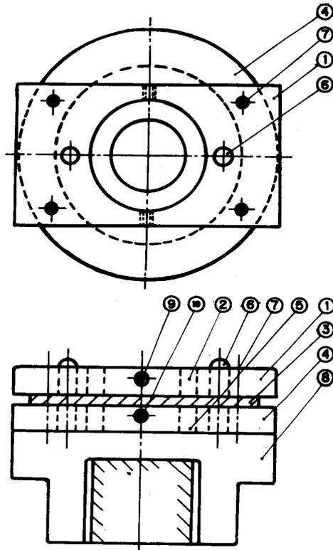
① Die holding plate ② Upper die ③ Plate (Specimen) ④ Die holding ⑤ Die
