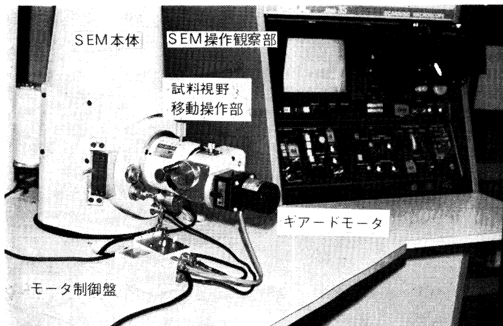
図2. 走査電子顕微鏡 (JSM-35型) に装着された走査電子顕微鏡内加工実験装置
