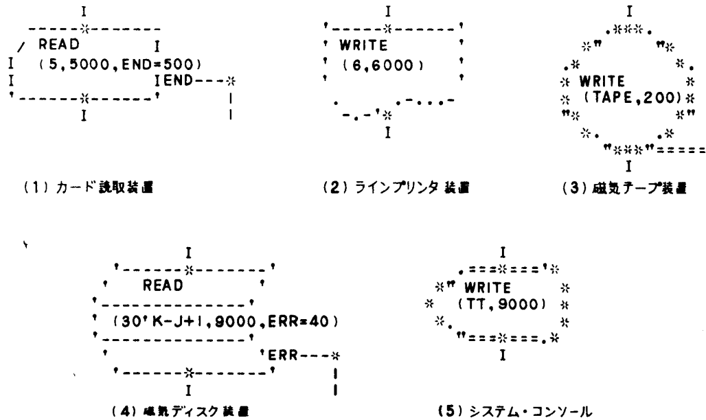
図 6. 入出力装置の流れ図記号
