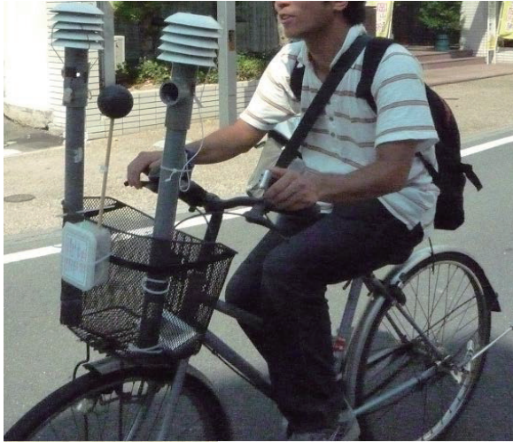
図5. 自転車による移動気象観測の様子. 前カゴに取りつけた白い放射シールド部のなかに温度測定センサーが挿入固定されている.
