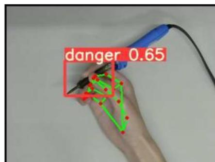
図3(c) 周囲に工具が無く、危険な持ち方の場合
