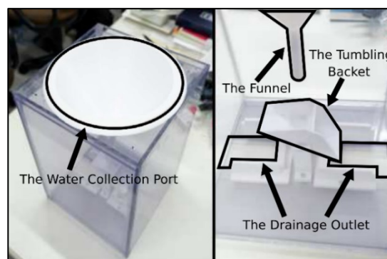
図2(d) 転倒マス式雨量計
