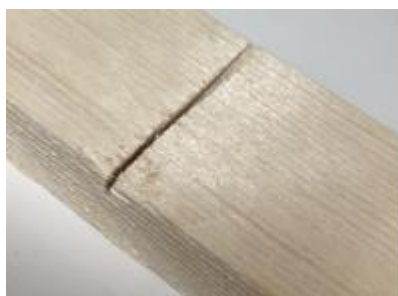
図7 第三段階（途中）：刃全体を使って切る
