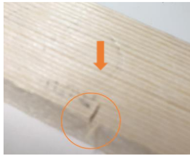
図6-2 第一段階：刃でつけた切れ込み
