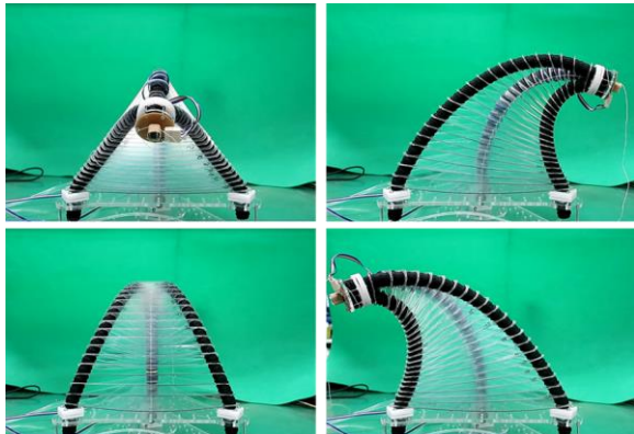
図6 四面体型アクチュエータの動作
