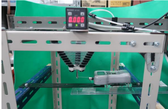
図13 試作TSAの曲げ剛性/発生トルク特性の実験風景
