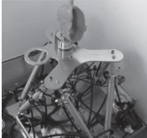
図 1-3 高岩らによるパラレルリンクマニピュレータ
