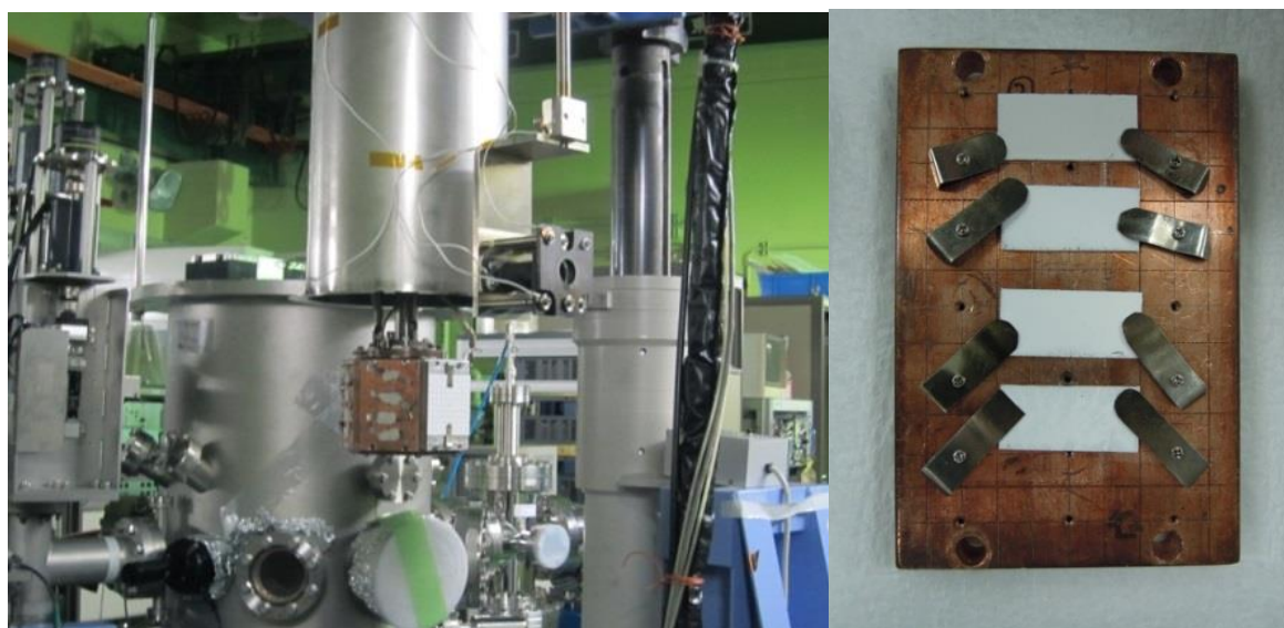
図 2.2 タンデム加速器を用いた He + イオン照射実験
