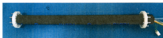
図12 センサ内蔵型人工筋の外観
