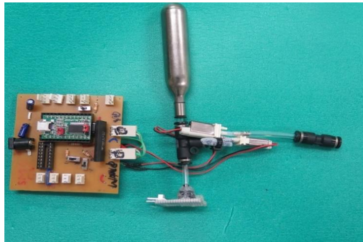
図 5-2 圧力制御システムの外観
