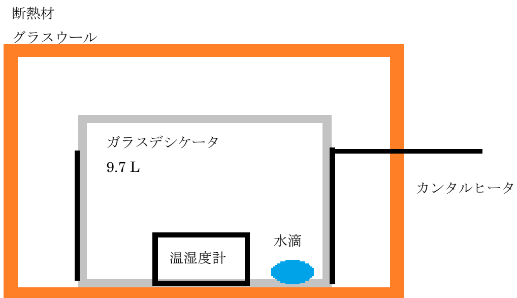
図 2.13 湿度測定装置の概略. ヒーターをガラスデシケータに巻き付けて昇温した. 水滴量はコールドトラップで捕集した水分量に相当する.
