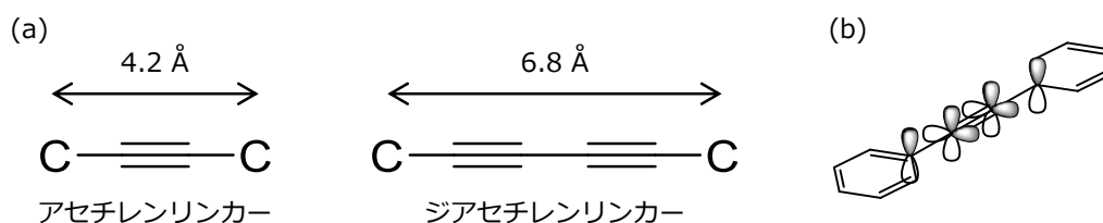
Figure 1-3. (a) アセチレンリンカーとジアセチレンリンカーの構造 (b) アセチレンリンカーの軌道. 3
