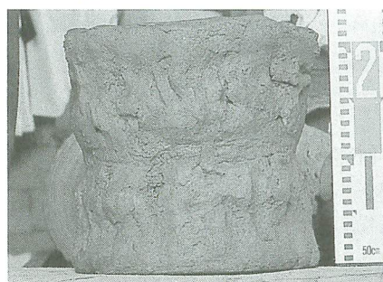
写真11 第1工程の成形体原型 [BPL]
