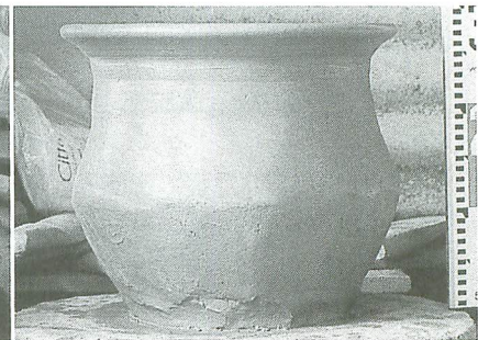
写真28 第2工程の成形体原型 [BPL]
