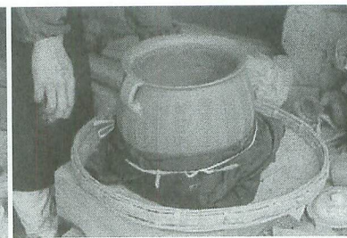
写真 56 過乾燥防止の布巻き [新平土鍋窯]
