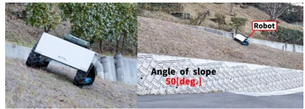
図8 横滑り抑制制御実験概要
