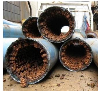
図1 錆が付着した配管内部
