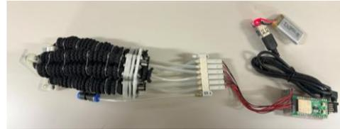
図4 従来の管内推進機構の外観
