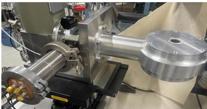
図1. 顕微光学クライオスタットの外観
