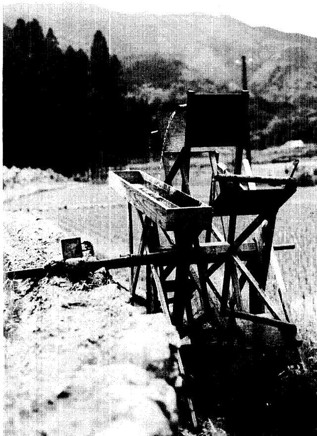
写真5 高知県高岡郡大野見村萩中 （水車番号12） 写真4と同じ戸田氏が作った水車だが、外周枠を細い木で柵型に取付け、簡便な作りとしている。しかし、水筒取付向きは写真4と同じである。
