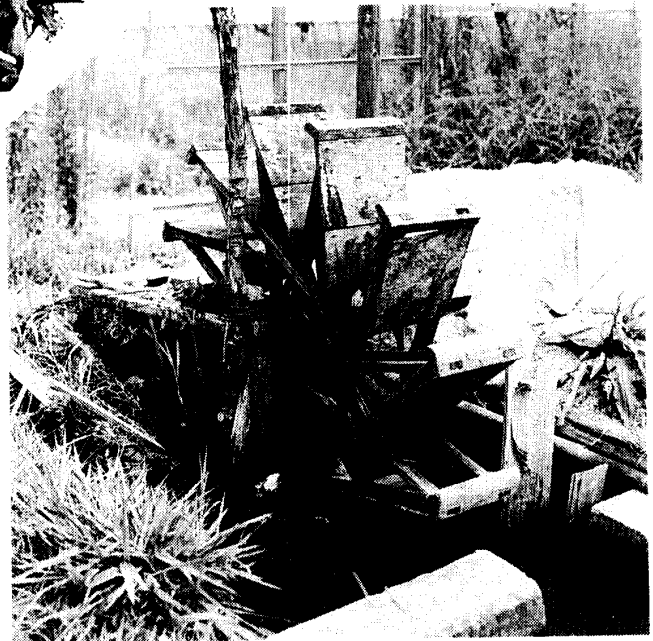
写真19 京都府綾部市位田町 明治時代以前より回っていると云う HD型の水車である。木枘を外周枠に吊るしている。
