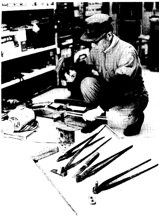
写真14 たがねによる鉄板の切断（宮本薫氏）。
