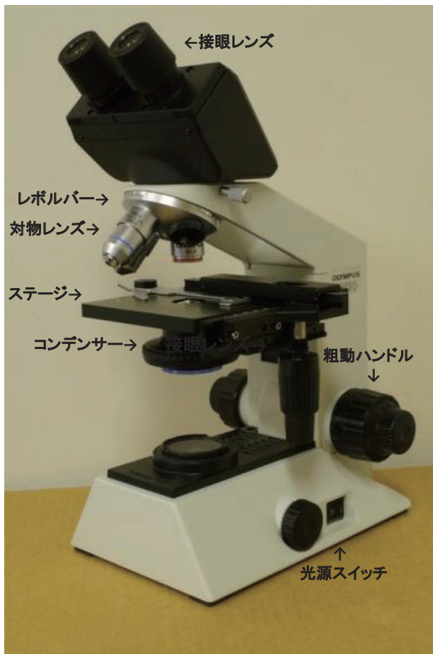
図2. 生物顕微鏡の各部の名称.
