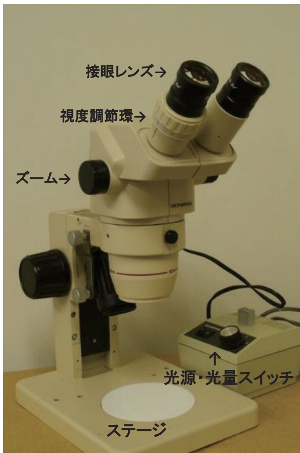
図3. 実体顕微鏡の各部の名称.
