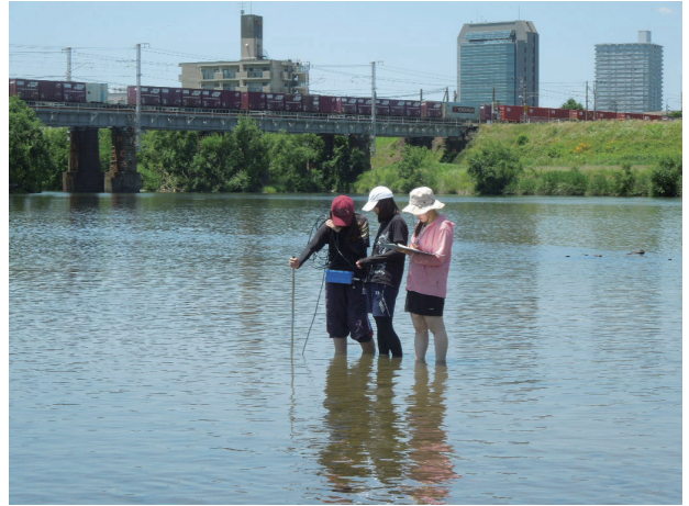
図 7. Stop 1 で、電磁流速計で測定する学生.
