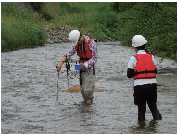
図 8. Stop 4 で電磁流速計を使用して流速を測定する学生.
