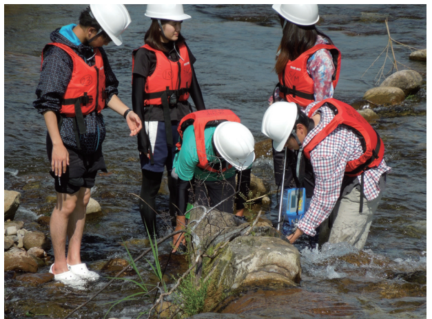
図 9. Stop 4 で電磁流速計を使用して巨礫の周辺の複雑な流速を測定する学生.
